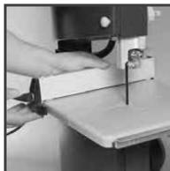
NOTA: Puede ser necesario girar el mango en sentido antihorario para poder deslizar la guía de corte sobre la mesa y luego en sentido horario antes de bloquear el mango en su posición.
