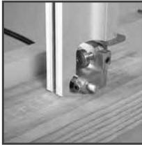
3- Para ajustar la altura de la guía superior de la cuchilla, afloje la perilla de bloqueo de la guía de la cuchilla y luego ajuste la altura usando la perilla de ajuste de la guía de la cuchilla.
