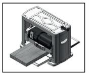
**Nota:** Al realizar cortes repetitivos, la pieza de trabajo se puede pasar sobre la parte superior del espesador utilizando los rodillos superiores.
