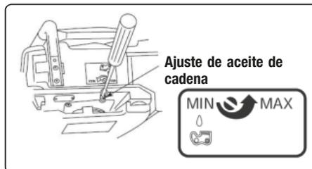
**Nota:** El tanque de aceite debe estar casi vacío en el momento en que se gasta el combustible. Asegúrese de rellenar el tanque de aceite cada vez que vuelva a cargar combustible.
