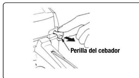
**Nota:** Cuando se reinicie inmediatamente después de detener el motor, deje la perilla del cebador en la posición abierta.
