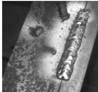
Detalle de costura con electrodo.
