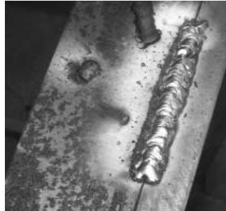
Detalle de costura con electrodo.
