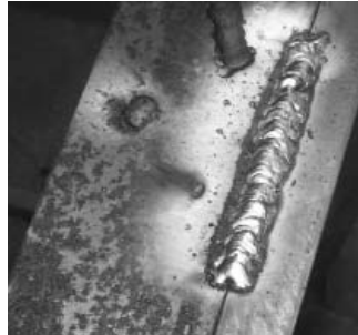
Detalle de costura con electrodo.
