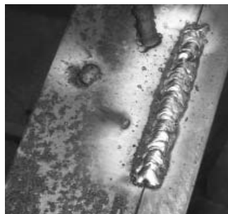
Detalle de costura con electrodo.
