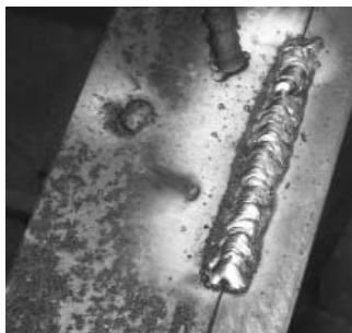
Detalle de costura con electrodo.
