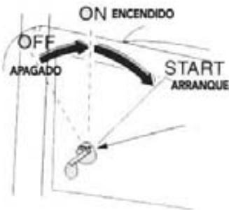
3. Gire el interruptor de encendido a la posición de OFF / APAGADO.
