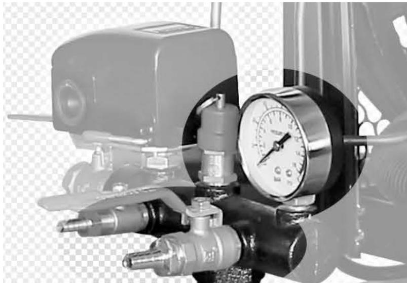
RELOJ DE PRESIÓN: INDICA LA PRESIÓN QUE TIENE ACTUALMENTE EL TANQUE EN SU INTERIOR
